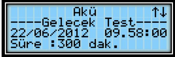
"Akü Testini Durdur" seçilirse cihaz testi iptal eder ve bir önceki çalışma durumuna geçer.
